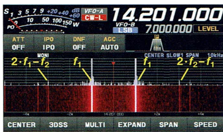
Bild 9: Entstehende IMD 3 -Störsignale bei P_i = -19 dBm
