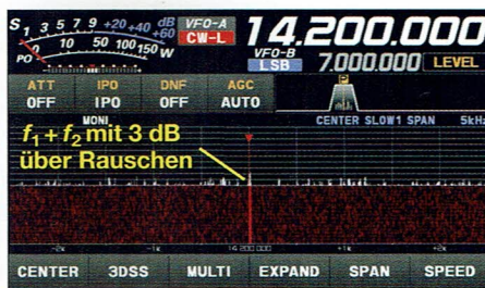
Bild 10: DR_2 -Störsignal bei P_i = -22 dBm, IPO
